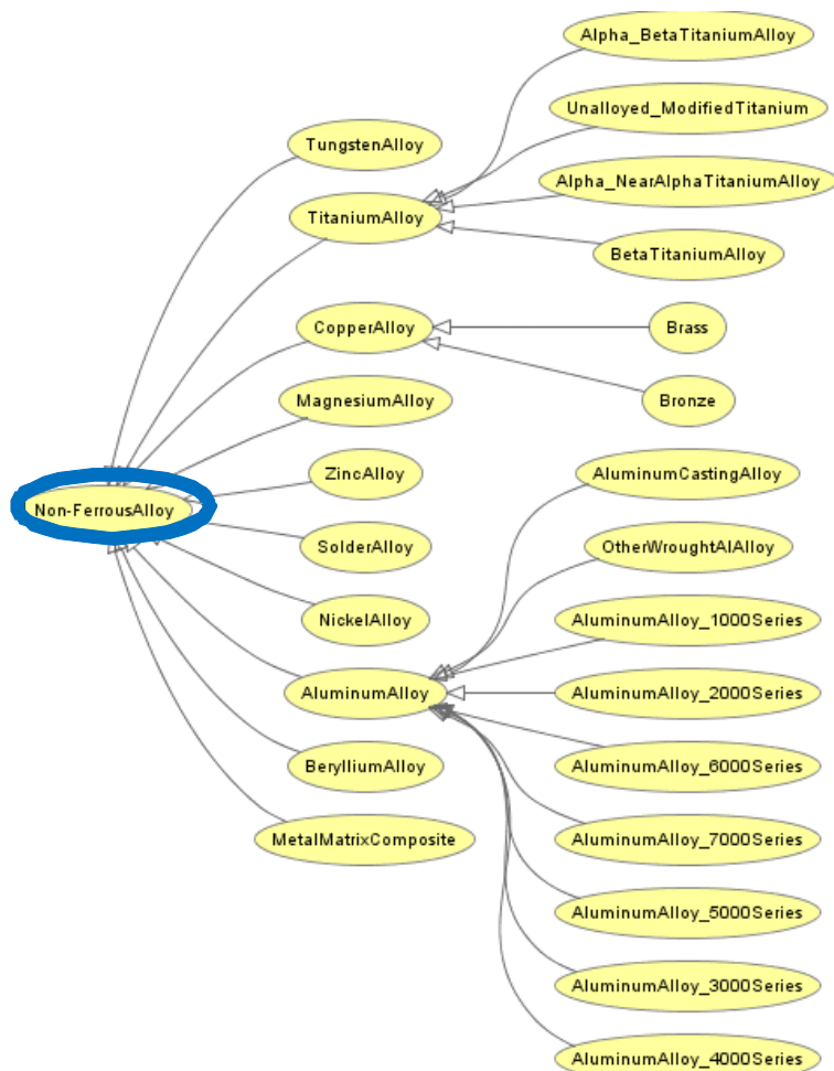
図 7. Substance オントロジー: Non-FerrousAlloy クラスの構成要素(クラスのみ)と要素間の関係
